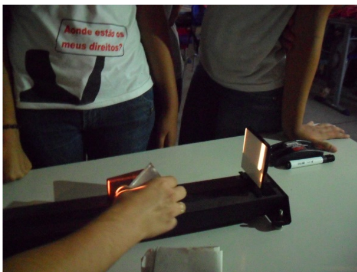
Fig. 3 – Experimento da dispersão da luz, utilizando um prisma.
